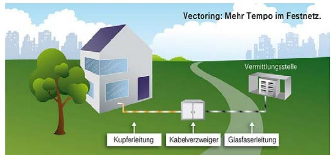
Durch Vectoring werden die elektromagnetischen Störungen ausgeglichen, die es zwischen den Kupferleitungen auf dem Weg in die Haushalte gibt. Das ermöglicht deutlich schnellere Datenübertragungen mit Geschwindigkeiten von bis zu 100 Mbit/s. Die Technik dafür wird in den Kabelverzweigern installiert.
